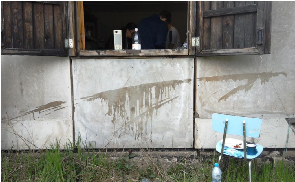
Obr. 6. Vodorovný „vrh“ pramínkem vody z plastové stříkačky
