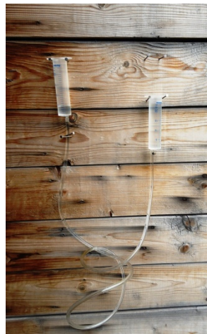
Obr. 5. Měření viskozity vody pomocí průtoku hadičkou mezi dvěma stříkačkami
