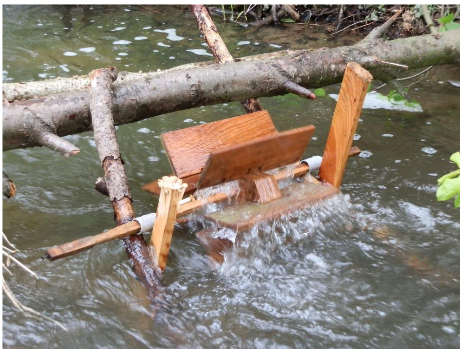
Obrázek 1: Mlýnek po instalaci ještě bez přenosového kola
