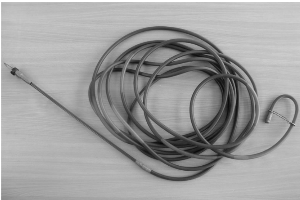
Obr. 2. Vodní barometr jako celek
