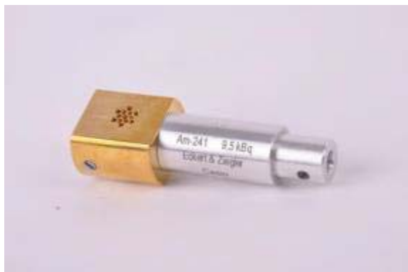
Obr. 2 - Školní zdroj záření ŠZZ ALFA
