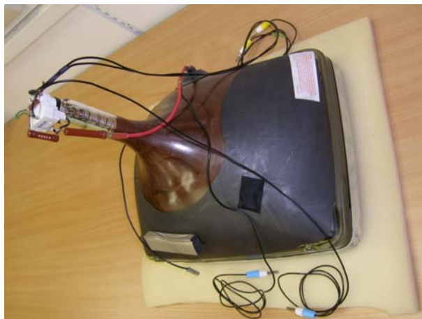
Obr. 2. Obrazovka bez vychylovacího systému
