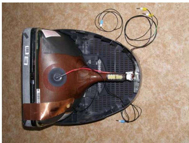
Obr. 1. Upravený monitor bez elektroniky a vychylovacího systému
