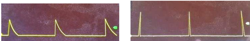
Obr. 2. Průběh proudu LEDkami v závislosti na čase (fotografie z osciloskopu).
