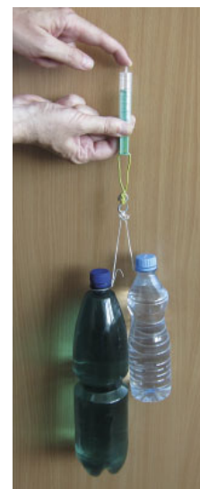
Obr. 2 Atmosférický tlak lze přibližně změřit pomocí plastové stříkačky a závaží.
