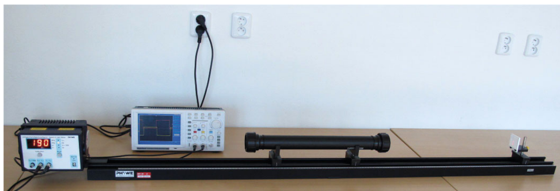
Obr. 5 Moderní pomůcky umožňují měřit rychlost světla ze vzdálenosti a doby šíření.
