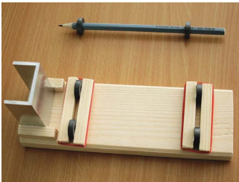
Obr. 4. Magnety na základní destičce drží mezi dvojicemi hranolků, které k sobě přitahují gumičky
