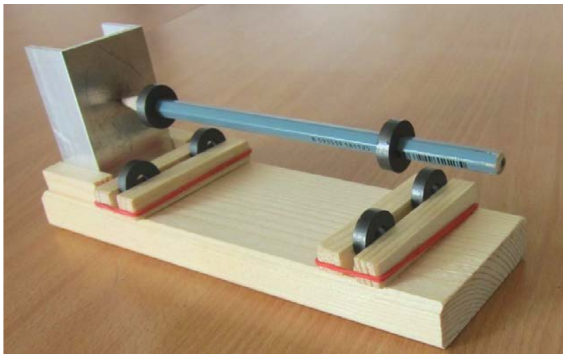
Obr. 2. Konstrukce („laditelná levitující tužka“), s níž můžeme dělat pokusy.
