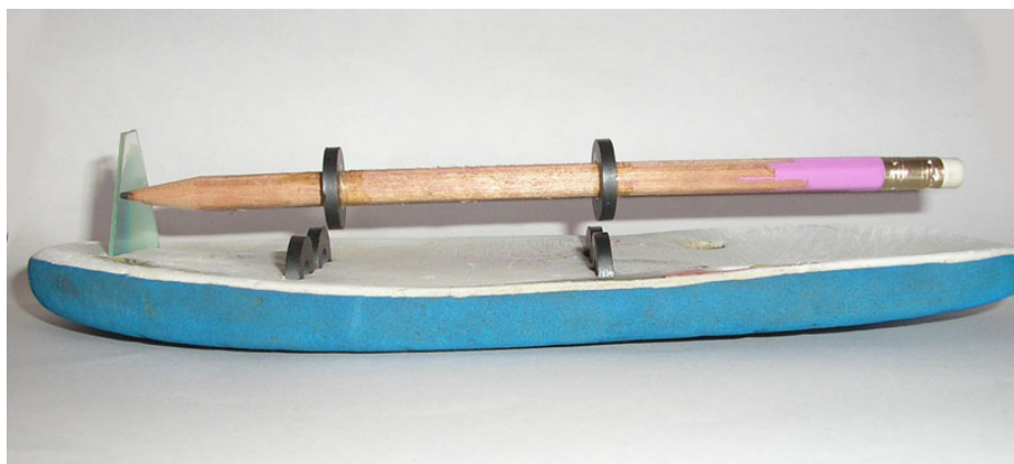
Obr. 1. Magnety nadnášejí tužku – konstrukce Arwinda Gupty (fotografie převzata z jeho webové stránky [4]).
