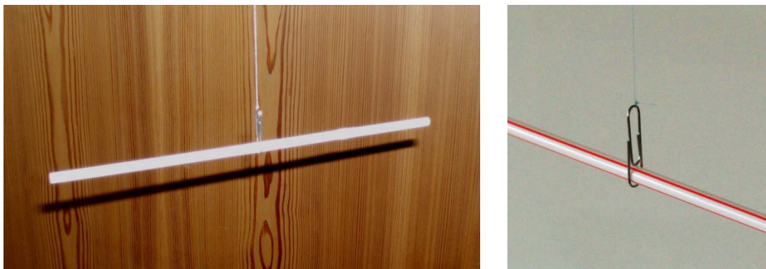
Obr. 7. Torzní vážky z brčka pro indikaci elektrostatického pole
