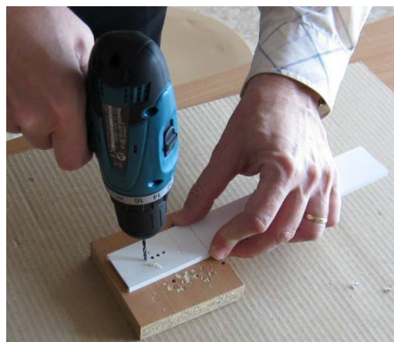
Obr. 9. Vrtání otvorů pro LED.
