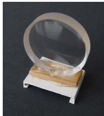
Obr. 7. Čočka přilepená na plastový „nosič“.
