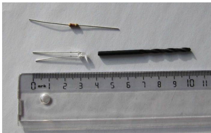
Obr. 3. LED průměru 3 mm, rezistor a vrtáček \varnothing 2,9 mm pro otvory pro LED.
