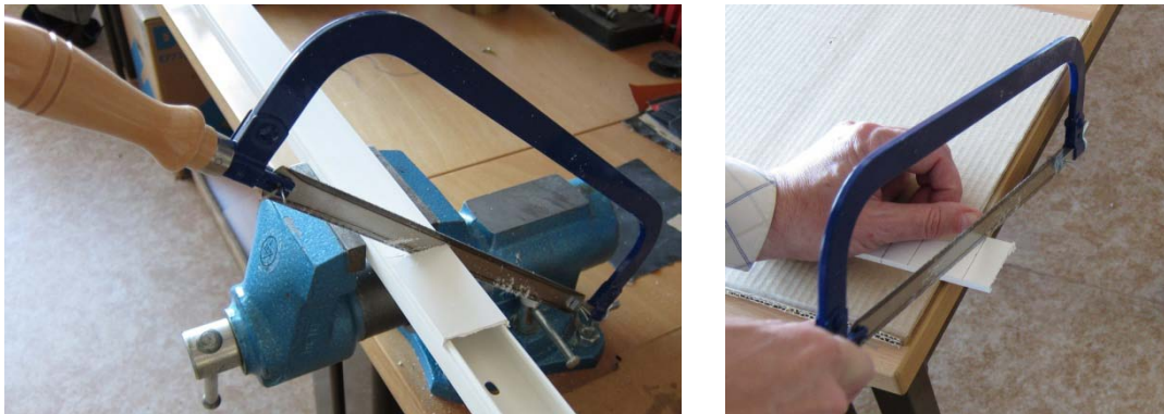
Obr. 4. Plastové lišty se dobře řezou pilkou na železo.
