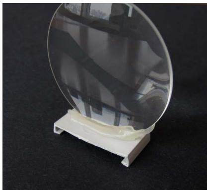
Obr. 7. Čočka přilepená na plastový „nosič“.
