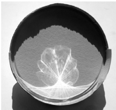
Obr. 3 Široký svazek paprsků ukáže i vadu zobrazení válcovým zrcadlem
