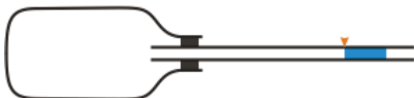
Obr. 1: Je-li trubička vodorovně, je v láhvi stejný tlak, jako v okolní atmosféře
