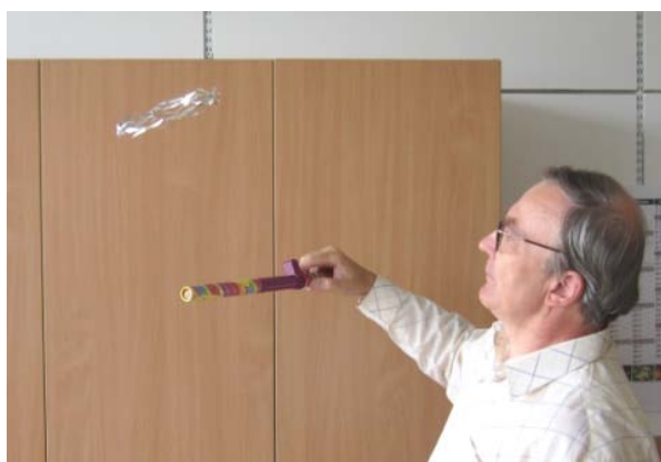
Obr. 2. Nabitý konec hůlky odpuzuje kroužek z fólie, který předtím hůlka nabíla
