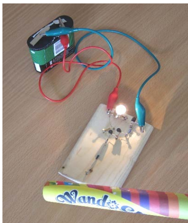
Obr. 3. Indikátor s tranzistory ukazuje, že magická hůlka na konci generuje kladný náboj
