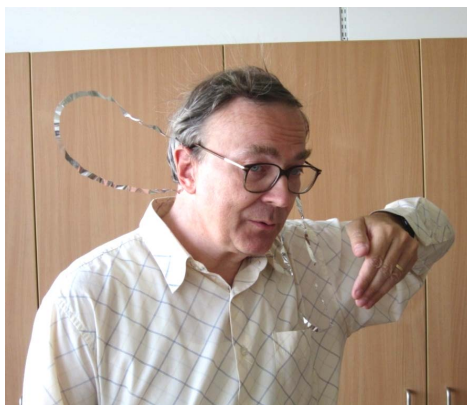
Obr. 9. Proužek fólie v „dutině“ mezi hlavou a rukou se nevychyluje, protože elektrické pole je tam (přibližně) nulové. (Proužek na druhé straně se od hlavy odpuzuje; indikuje tak, že člověk je opravdu nabitý.)
