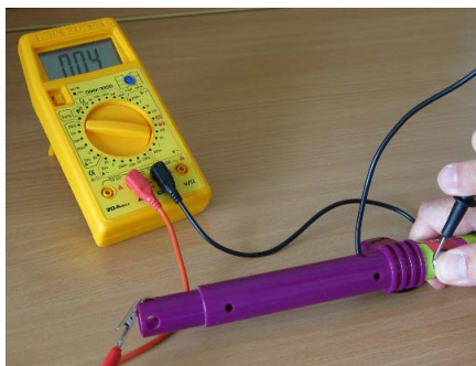
Obr. 6. Měření proudu, který magická hůlka dodává. (Na fotografii není vidět desetinná tečka před poslední číslicí; údaj je 0,4 \mu\text{A} .)
