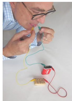
Obr. 2 - Měření citlivosti jazyka na procházející proud.
