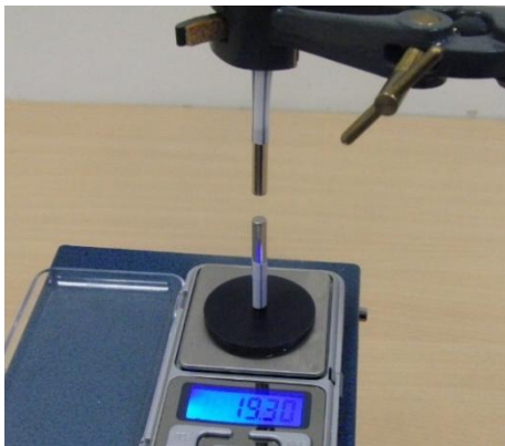
Obr. 5. Měření síly mezi dvěma magnety ( l = 25 mm; R = 2,5 mm)
