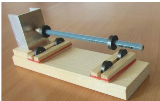
Obr. 1 - Odpuzování magnetů využité pro levitaci tužky (převzato z [3]).
