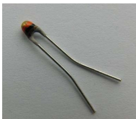
Obr. 1. Perličkový termistor 10 k \Omega a změřená závislost jeho odporu na teplotě
