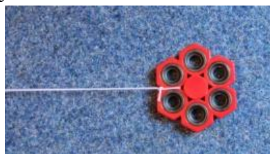
Obr. 4. Spinner s gumičkou jako torzní kyvadlo.
