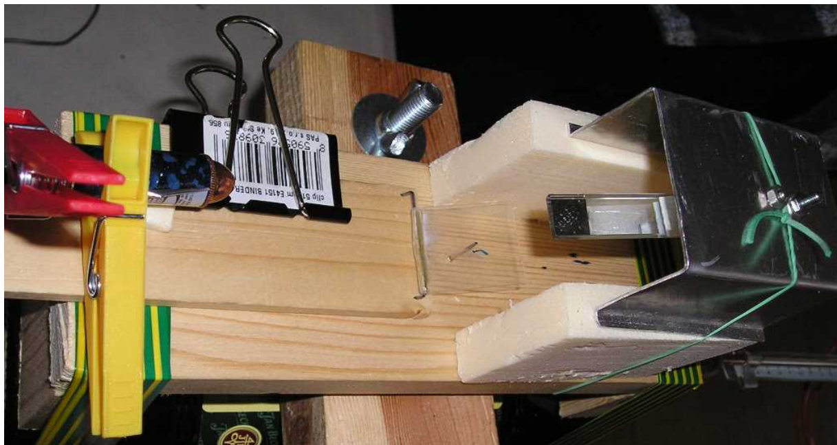
Detail uložení laseru, a optické soustavy zrcátek
