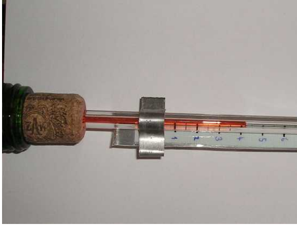
Detail kapiláry k měření změny objemu láhve.
